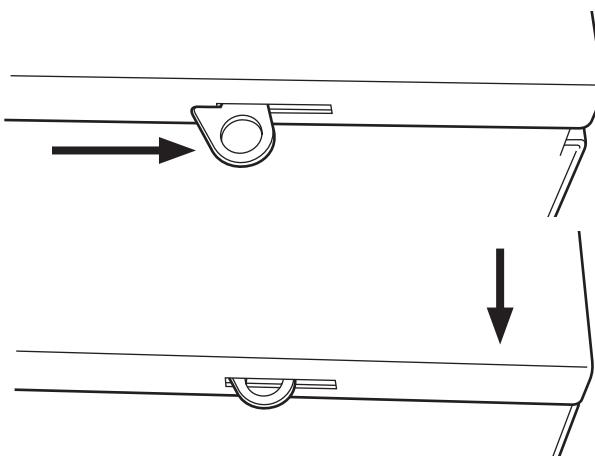
Pour fermer et verrouiller la porte, poussez la porte contre le boîtier. À cette position, poussez la porte vers le haut. Le verrouillage à ressort de la porte s'engagera alors et verrouillera la porte à cette position. La porte du boîtier DOIT être fermée et verrouillée en tout temps sauf lors de l'entretien du système.
