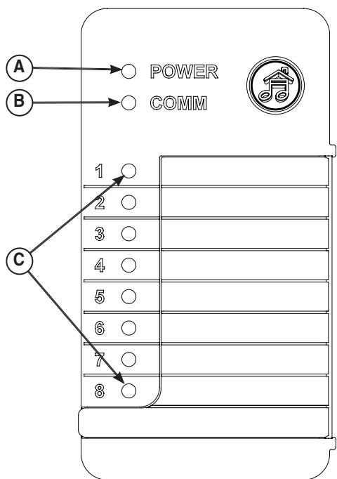
Symphony II, que muestra de manera visual el estado de encendido/apagado de cada carga/aparato gestionado. Varias luces de LED se encienden cuando un aparato recibe suministro de alimentación del generador y se apagan cuando el aparato está en modo de eliminación o no tiene energía. Cuando se utiliza el suministro de alimentación del generador, el consumidor puede ver qué aparatos se están gestionando.
